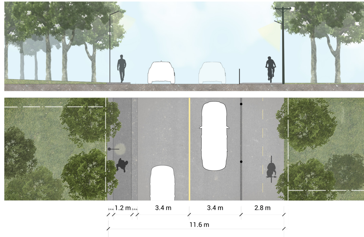
FIGURE 41: COUPE DE RUE PROJETÉE (MONTÉE DE L'ÉGLISE)
